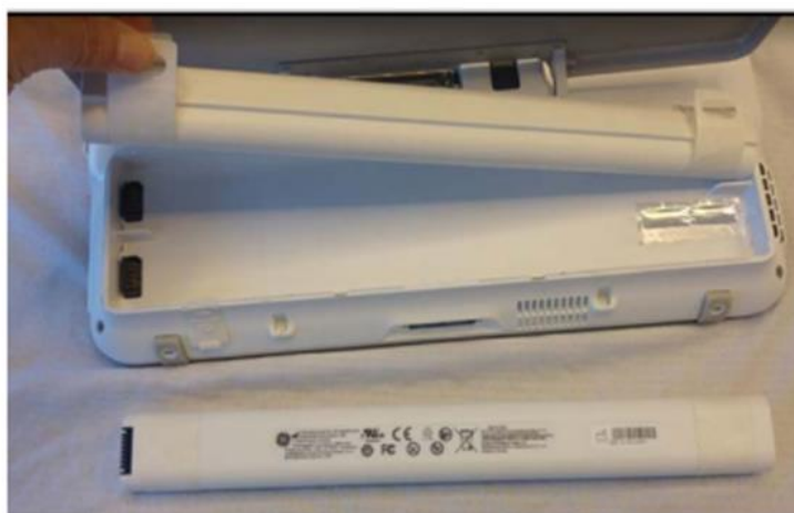
Slika 3-7. Uklanjanje druge baterije
