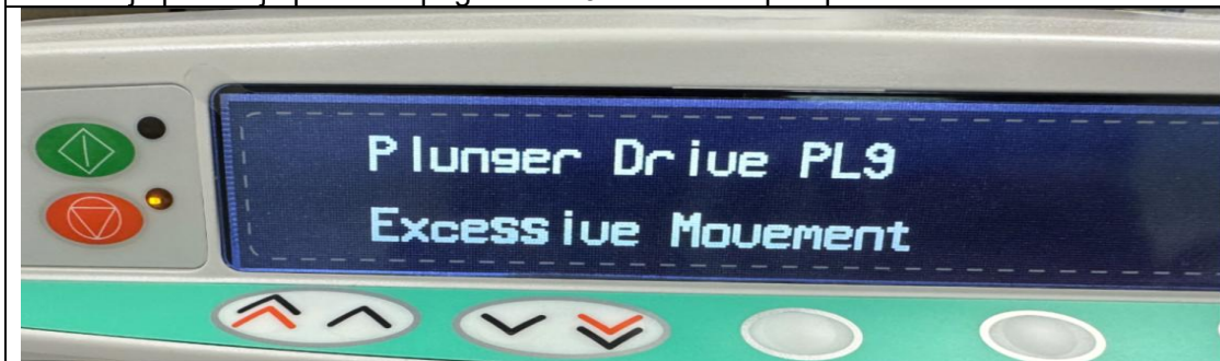
Slika koja prikazuje poruku o pogrešci PL9 na zaslonu pumpe
