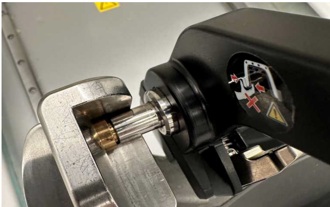
Slika 3. Ispravno priključen i poravnat adapter.
