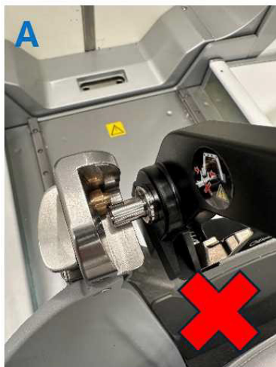
Slika 2. A, B neispravno priključivanje s nepravilnim adapterom, C ispravno poravnatim priključivanjem.
