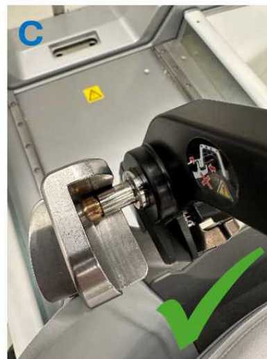
Slika 2. A, B neispravno priključivanje s nepravilnim adapterom, C ispravno poravnatim priključivanjem.
